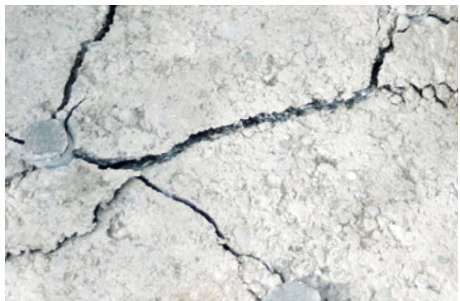
Abb. 9 Spalten durch Quelldruck
